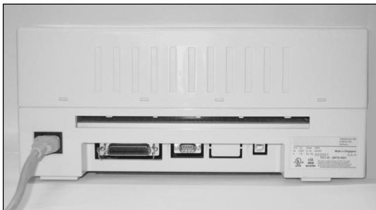
Branchez le câble électrique à la prise d'admission électrique de l'imprimante. Branchez la fiche du câble électrique dans une prise de secteur.
