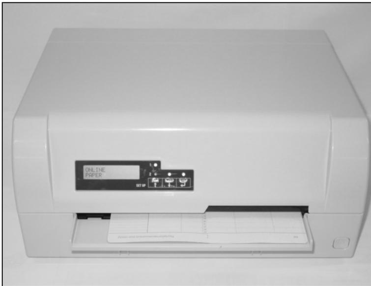
Placez le livret d'épargne sur le côté droit du support pour documents, avec la page à imprimer faisant face en haut. Le livret doit être inséré dans l'ouverture de la glissière. Une fois qu'il est dans la glissière, le mécanisme de l'imprimante prend le livret. À ce moment, vous pouvez relâcher le livret car l'imprimante l'alignera de nouveau contre sa butée droite pour le charger dans l'imprimante.
