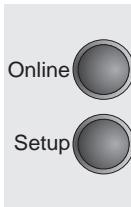
Taste **Setup** drücken. Der Drucker wechselt in den Setup-Modus.
