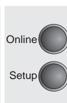
Premere il tasto **Online** per portare la stampante nella condizione „pronta al funzionamento“. Se la stampante riceve i dati dal computer, il foglio singolo viene automaticamente trascinato all'interno. Premere il tasto **Load** (4) per caricare il foglio singolo prima dell'inizio della stampa.
