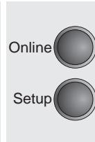
Taste **Setup** drücken. Der Drucker wechselt in den Setup-Modus.
