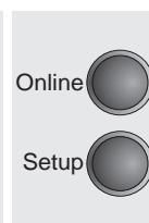
Appuyer sur la touche **Online** pour que l'imprimante soit prête à fonctionner. Si l'imprimante reçoit des données de l'ordinateur, la feuille simple est chargée automatiquement. Appuyer sur la touche **Load** (4) pour charger la feuille simple avant impression.
