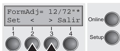
Por medio del pulsador < (2) o > (3) ajuste la primera línea de impresión a la posición deseada. Se pueden ajustar valores entre 0 y 220/72" para papel continuo y para hojas sueltas.
