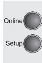
Appuyer sur la touche **Setup**. L'imprimante passe en mode Setup.
