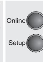
Presione el pulsador **Setup**. La impresora cambia al modo Setup.
