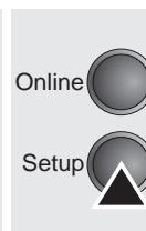
Presione el pulsador **Setup**. La impresora se pone al estado inicial. Alternativamente puede presionar el pulsador **Online**. Entonces la impresora cambia al modo Online directamente.
