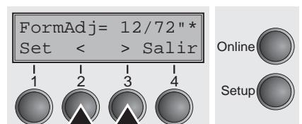
Por medio del pulsador < (2) o > (3) ajuste la primera línea de impresión a la posicón deseada. Se pueden ajustar valores entre 0 y 220/72" para papel continuo y para hojas sueltas.
