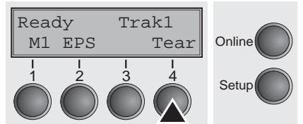
Der Drucker transportiert standardmäßig das Papier nach dem Einlegen in die Tearposition. Wenn Sie diese Funktion im Menü des Druckers deaktivieren (Einstellung: **Manual**), wird Endlospapier mit der Taste **Tear** (4) in Abreißposition gefahren.
