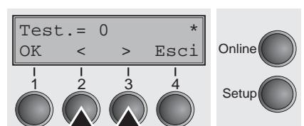
Con il tasto < (2) o > (3) impostare il campo di correzione per l'impostazione automatica della distanza della testina di stampa. Si possono selezionare valori compresi tra -10 e +10.
