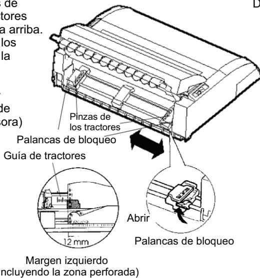
D) Encaje los agujeros del papel continuo en las patillas de los tractores derecho e izquierdo. Ajuste el tractor izquierdo (visto desde detrás de la impresora) al ancho del papel. Cierre las pinzas de los tractores.
