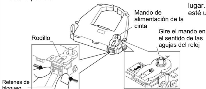
Alinee la posición del cabezal de impresión con el punto (verde) que se encuentra en la tapa de expulsión. Ubique la cinta entre el cabezal de impresión y la guía de impresión, luego presione con suavidad hacia abajo el cartucho de cinta hasta que encaje en su lugar. (Asegúrese de que el mando de alimentación de la cinta esté ubicado mirando hacia arriba.)
